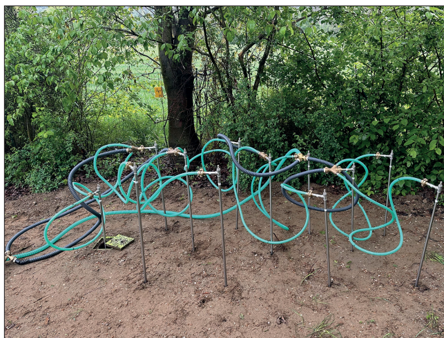
Messaufbau Ausbläser (l.) und Sondenfeld zur Messung der Leckstelle an erdverlegter Gasleitung, „Teststrecke“ (r.)
