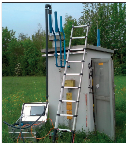
Messaufbau Ausbläser (l.) und Sondenfeld zur Messung der Leckstelle an erdverlegter Gasleitung, „Teststrecke“ (r.)
